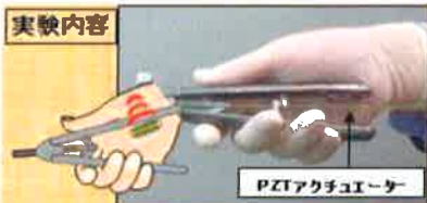
振動子をつけた鉗子で手に振動を与え内視鏡下腹腔鏡手術を行う
